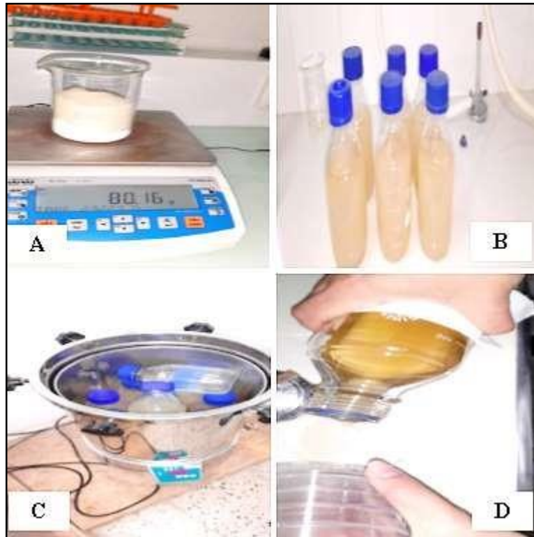
Figure 8. Préparations les milieux de cultures utilisés. (A) pesage des composants ; (B) mise en flacons autoclavables après mesure du pH ; (C) stérilisation liquide à l'autoclave 20min à 120°C ; (D) le milieu est versé dans des boîtes de Pétri en conditions stériles
